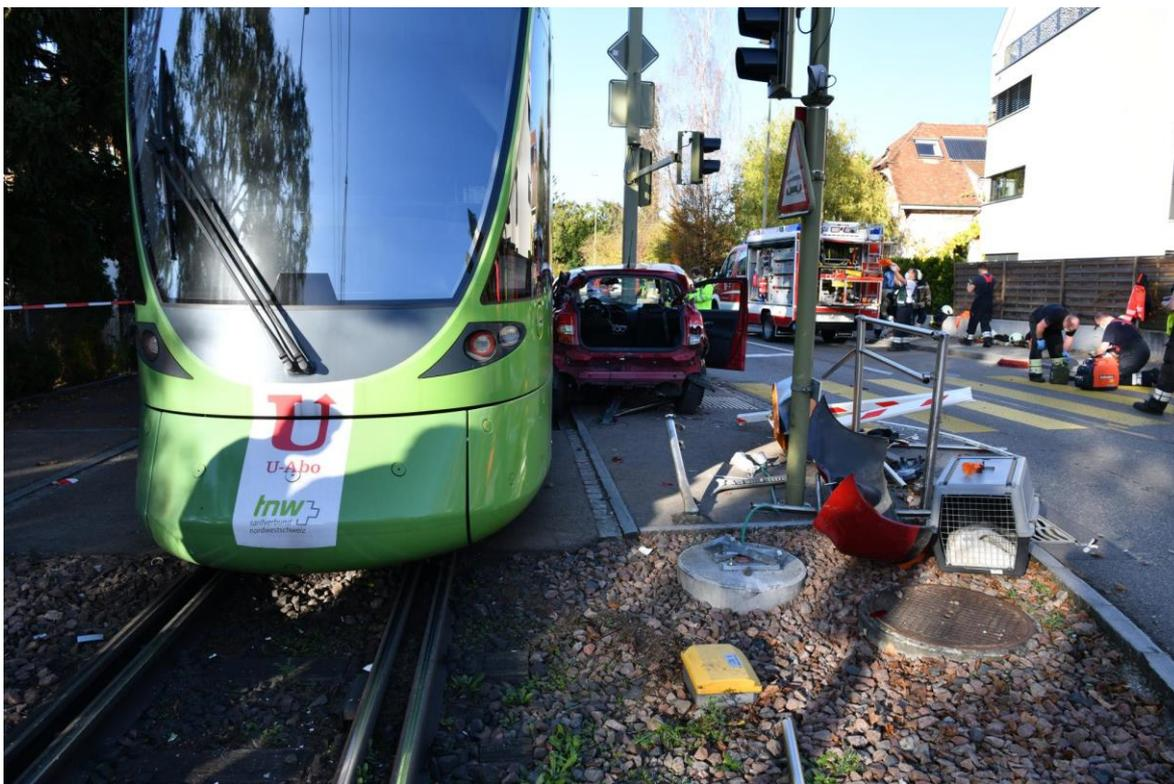
Abbildung 2: Personenwagen und Tram in Endlage mit abgetrenntem Schrankenantrieb
