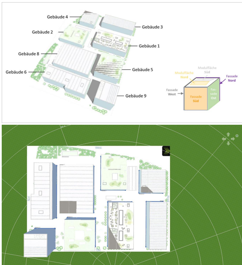
Abbildung 12: 3D-Arealmodell im Programm PV*SOL
